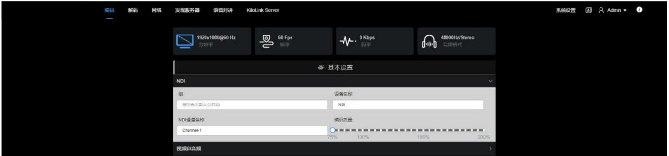
设备处于解码器工作模式时，将自动搜索网络中的 NDI 源，并显示于解码管理界面的下方。找到要解码显示的 NDI 源，点击其右边的图标
