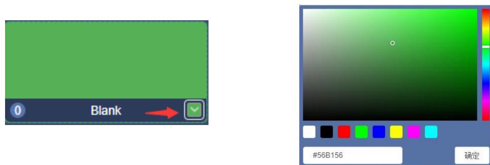
点击右侧图标 ，进入平滑切换设置。当视频较大或者传输较慢时，设置较长的平滑时间可以保证切换画面达到更好的平滑切换效果，否则当切换后画面还未输出时会显示设置的 Blank 画面。
