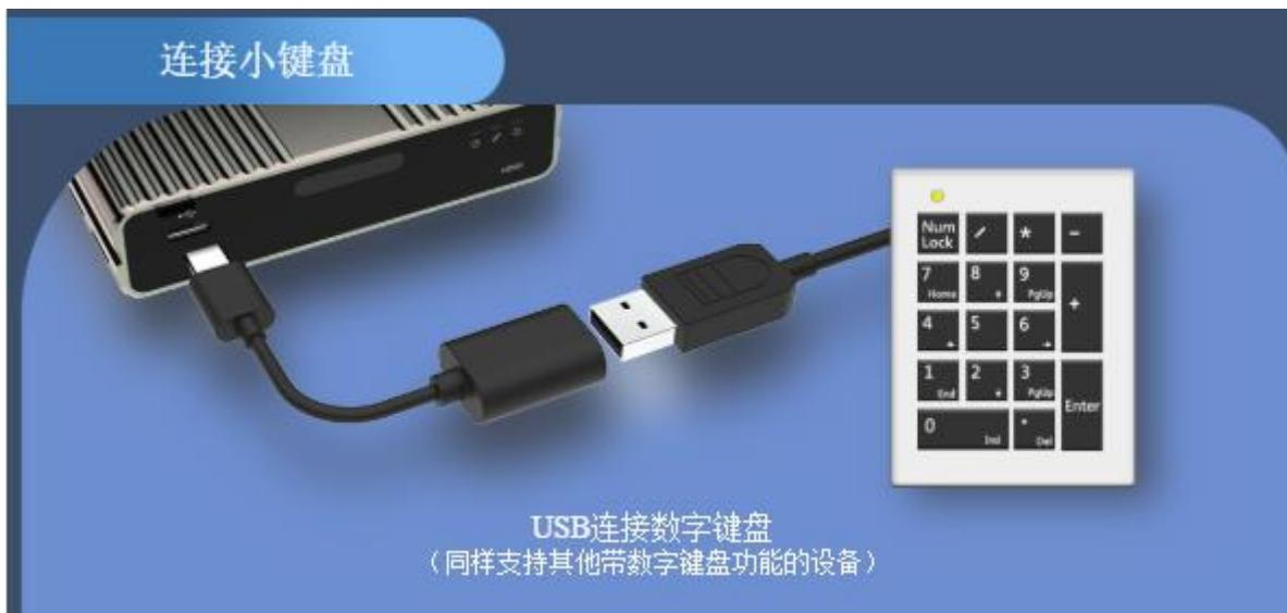
然后打开键盘上的【Numlock】键，灯亮表示连接正常，可进行切换操作。通过数字按键切换选择相对应 1-9 的解码预设，0 选择 Blank
