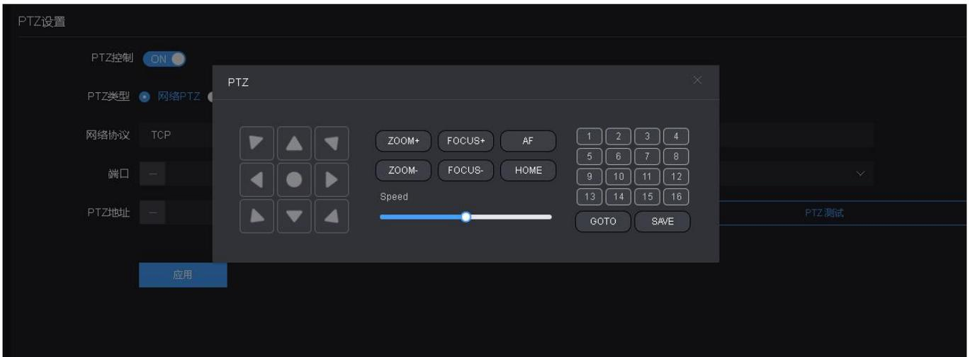
测试成功后，您可以在设备的管理系统的编码模式下点击
