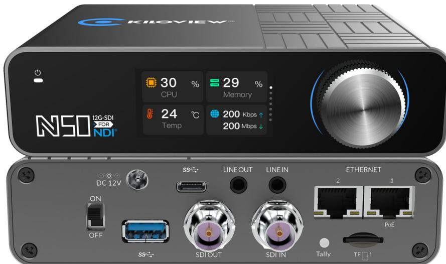
N50 同时支持 SpeedHQ 和 AVC(H.264)/HEVC(H.265)的编解码，这意味着 N50 可以同时支持 NDI High Bandwidth 和 NDI HX 的 IO 转换——在编码模式下，N50 可以同时向外界输出高达 4K 分辨率的 NDI High Bandwidth 和 NDI HX 视频码流；在解码模式下，N50 可以自动适配 NDI High Bandwidth 和 NDI HX 的码流格式。运用 NDI 技术，结合 Kiloview 自身对于视频编码和网络传输技术的深度优化，N50 可以实现视频从编码到解码低至 80ms 的超低延时。
