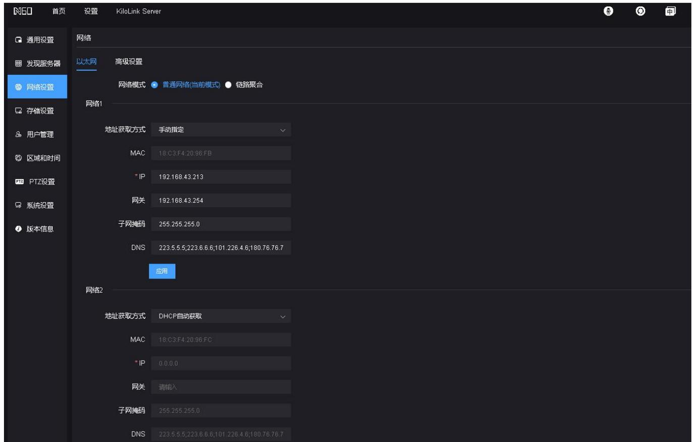
在普通网络模式下，可以分别配置设备的两个以太网口，配置支持 DHCP 自动获取网络信息和手动指定两种方式，手动指定方式下，用户可以自己设置 IP、网关，子网掩码，以及 DNS 信息。如果要设置多个 DNS 服务器，可以用分号“;”将各个 DNS 地址隔开。
