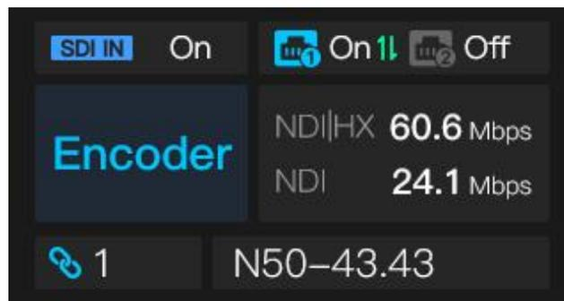
在当前页面按下旋转滚轮后，可进入子菜单，子菜单页面支持修改 N50 的工作模式选择 Model 即可进入设置，将 N50 从 Encoder (编码模式) 切换至 Decoder (解码模式)。同时支持修改编码质量。
