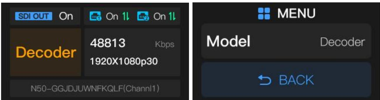
在当前页面按下旋转滚轮后, 可进入子菜单, 子菜单页面支持修改 N50 的工作模式, 将 N50 从 Decoder (解码模式) 切换至 Encoder (编码模式) 。
