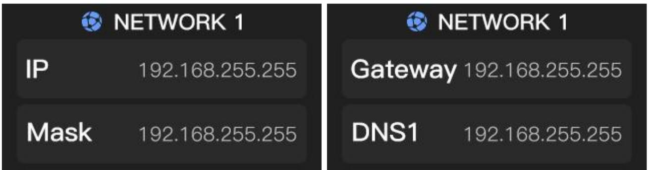
如果需要手动修改 IP 地址, 请选择 IP, Mask, Gateway, 进行单独修改。通过旋转滚轮上下滚动可调整 IP 地址的数字, 设置完成后按下旋转滚轮然后选择 OK, 即可保存该, 如下图:
