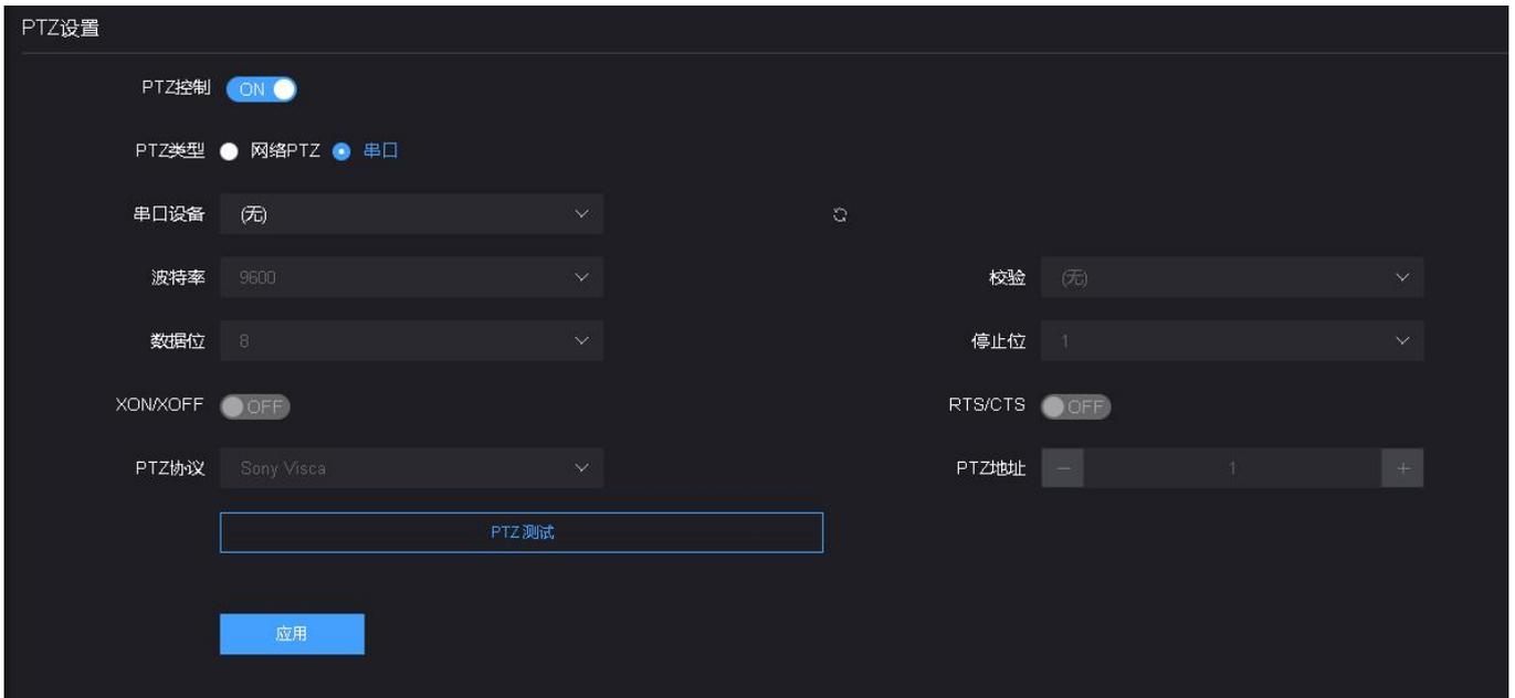
如果您要使用基于网络协议的 PTZ 控制，只需在 PTZ 设置中选择网络，并设置正确的网络连接参数与 PTZ 控制协议。
