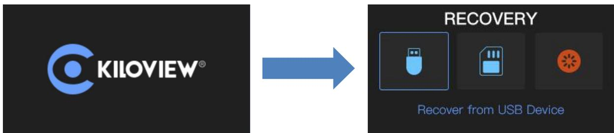
第三步：通过旋转滚轮旋钮选择“Recover from USB Device”（从 U 盘安装固件）或者“Recover from SD Card”（从 SD 卡路径安装固件），选择完成后按下滚轮旋钮确认即可开始升级。
