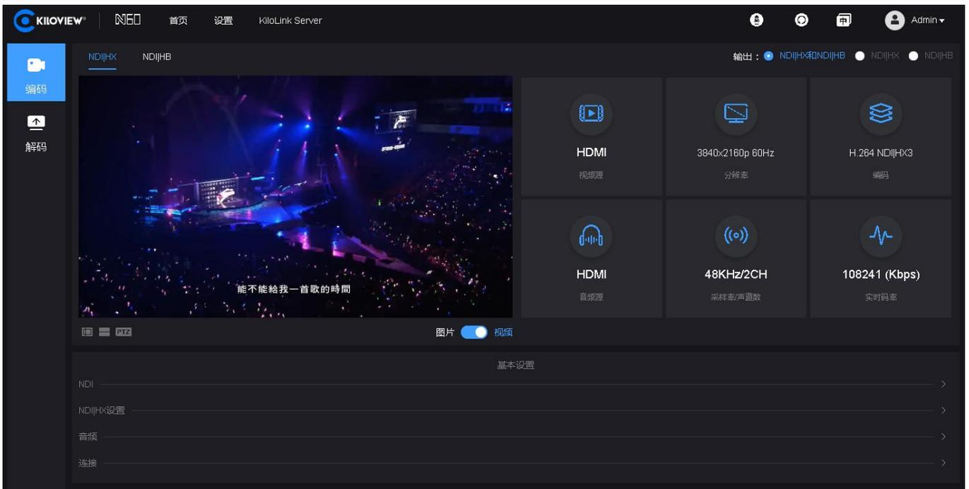
设备管理顶部有导航栏，分别可以进行切换设备首页，设置页，联接 KiloLink Server,语音对讲，设备重启，切换言语（中英文），以及修改密码与，登出系统等操作。
