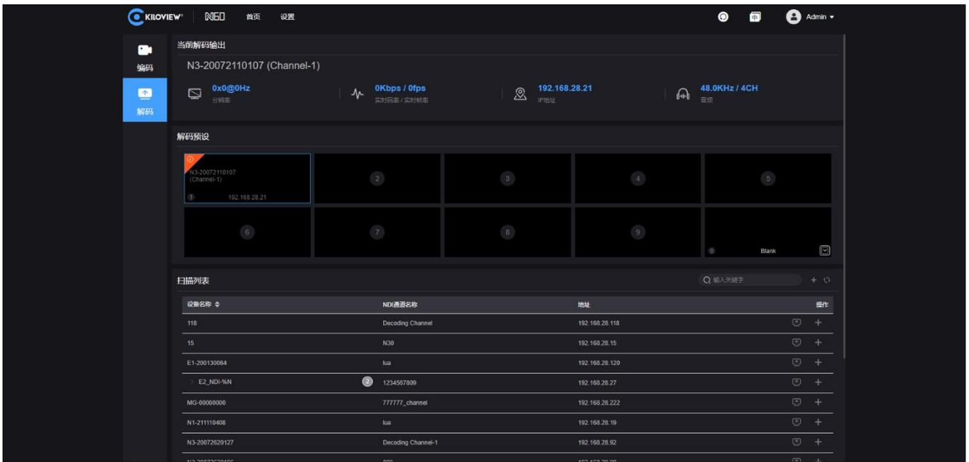
**⚠注意：本设备编码和解码不可同时进行，当切换到解码功能后，设备编码功能停止工作。**
