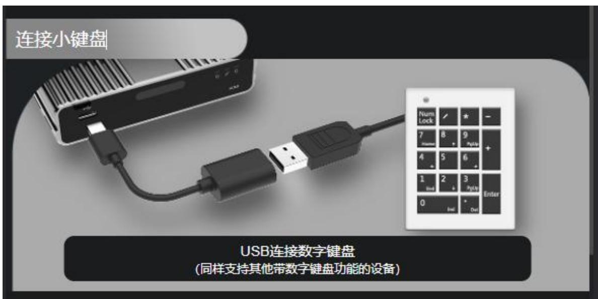
然后打开键盘上的【Numlock】键，灯亮表示连接正常，可进行切换操作。通过数字按键切换选择相对应 1-9 的解码预设，0 选择 Blank。
