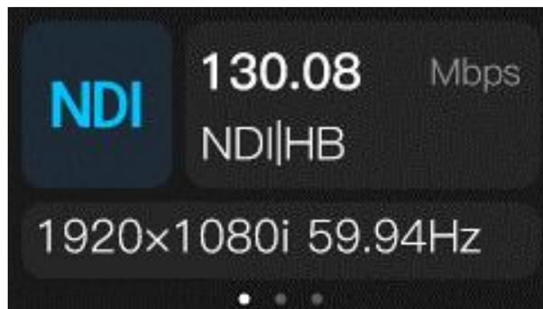
在当前页面按下
