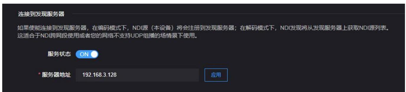
**⚠ 注意：**开启此功能后，mDNS 自动发现功能无效。编码器输出视频流只能发送给指定的服务器，接收端必须注册到同一个发现服务器才能拉取 NDI 流。
