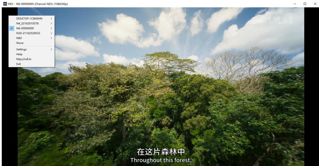
打开 Monitor 工具播放 NDI 的视频后，点击播放器右下角的齿轮状按钮
